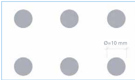
Muster eines Punktrasters mit 25%-iger Deckung, Ø 10 mm, dargestellt im Massstab 1:1.
