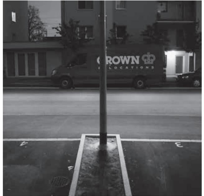
Abb. 4 Gute Abschirmung bei moderner Strassenbeleuchtung (2012). Neue Warmweiss-LED Leuchten kommen schon nahe an das Optimum aus Sicht von Dark-Sky Switzerland. Eine typische Strasse mit Wohnanteil in Wallisellen zeigt, dass die angrenzenden Häuser mit Schlafräumen unbehelligt bleiben, während der Strassenraum, die Trottoirs und Parkplätze genügend hell und sicher sind.
