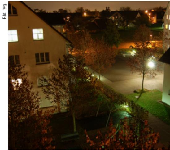
Ein Problem und seine fachmännische Erklärung: Der Blick in die SIA 491 zeigt die vielen möglichen Wirkungen ungerichteten Lichts, hier anhand einer Kugelleuchte. Das Licht wird nicht nur rundum abgestrahlt, sondern auch vom Boden und der Fassade reflektiert.
