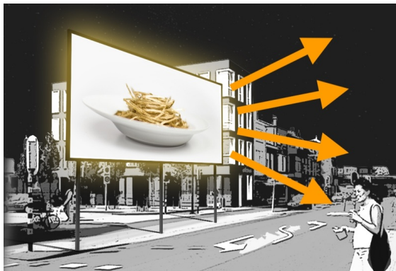
Abbildung 25: Werbereklame strahlt das Licht unkontrolliert ab.
