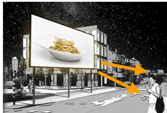
Abbildung 26: Mit einer Spezialfolie wird das Licht nach unten gerichtet, somit ist das Problem entschärft.
