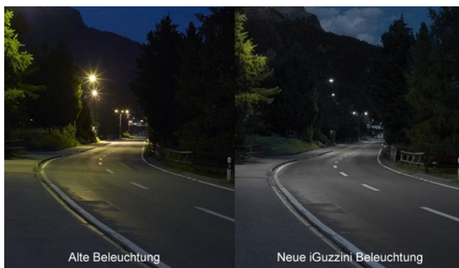
Abbildung 22: Beleuchtung von Pontresina, links mit Quecksilberbeleuchtung, rechts mit neuer LED.
