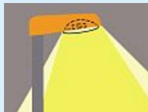
Wenig Lichtverschmutzung und gute Energieeffizienz dank liegendem Leuchtmittel, Lichtabstrahlung nach unten, Reflektor und Klarglas.
