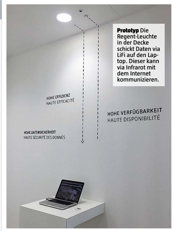
LED schnell ein- und ausgeschaltet – fürs Auge nicht wahrnehmbar. **Für den Empfang braucht eine Fotozelle. Um Daten zurückzusenden wird Infrarot genutzt.**
