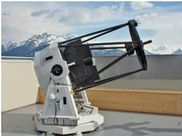
Abb. 13: Teleskop Cassegrain der Sternwarte Mirasteilas
