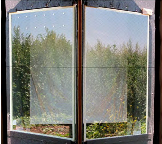
Eastman Saflex® FlySafe™ SEEN shiny 9/90: metallische Punkte mit 9 mm Durchmesser im Abstand von 90 mm: hoch wirksam und wegen der hohen Reflektanz auch für Position 2 geeignet (links Prüf-, rechts Referenzscheibe).
